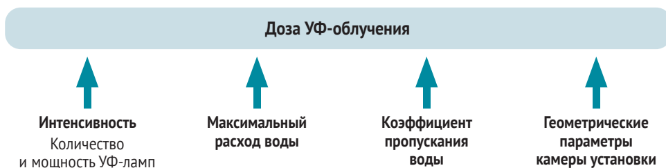
Рис. 47. Параметры для выбора УФ-оборудования
