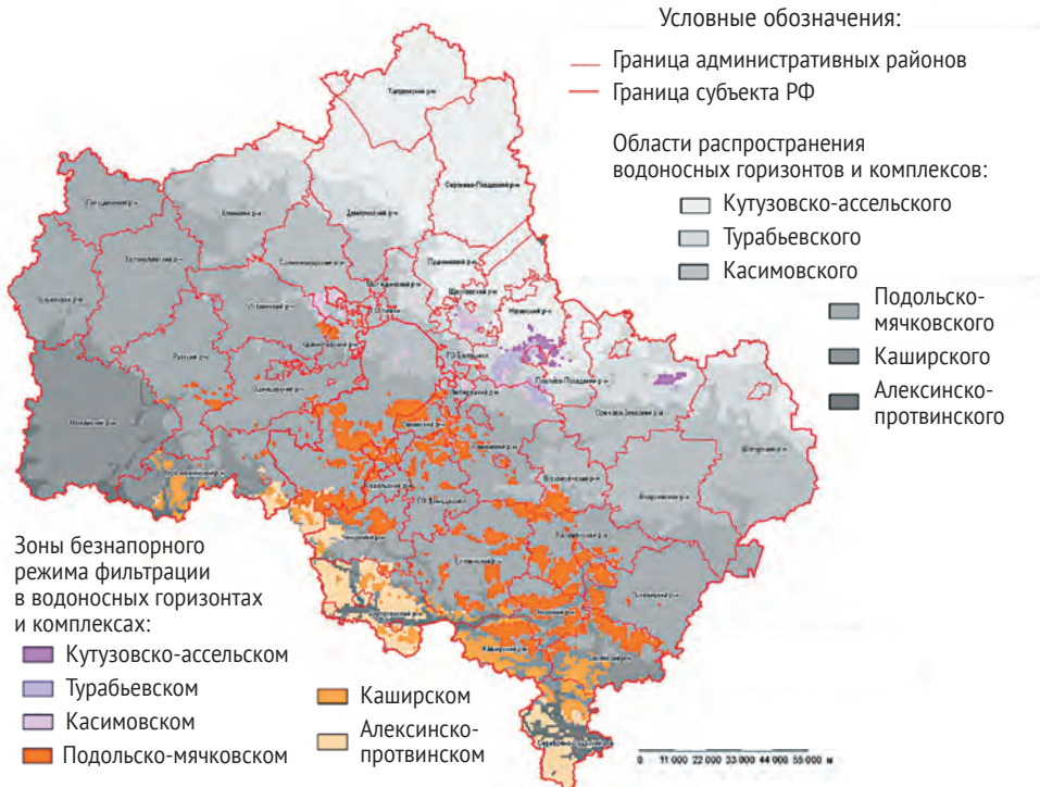
Рис. 21. Модельная схема зон безнапорного режима фильтрации в эксплуатируемых водоносных горизонтах и комплексах Московского региона (по данным мониторинга подземных вод АО «Центральное ПГО». М., 2014)
