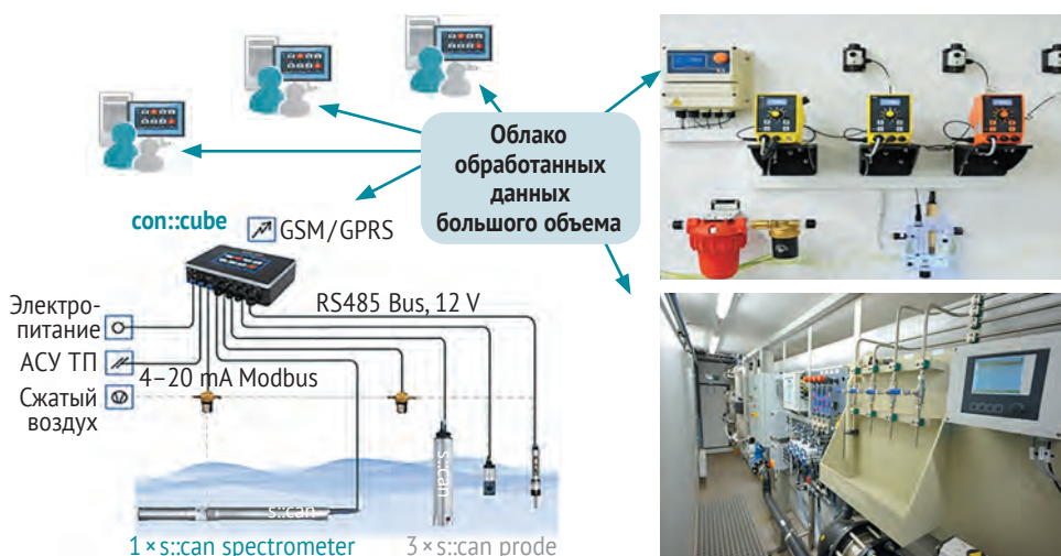
Рис. 55. Организационная модель регулирования параметров процесса водоподготовки (на примере управления качеством воды) на основе применения методов искусственного интеллекта
