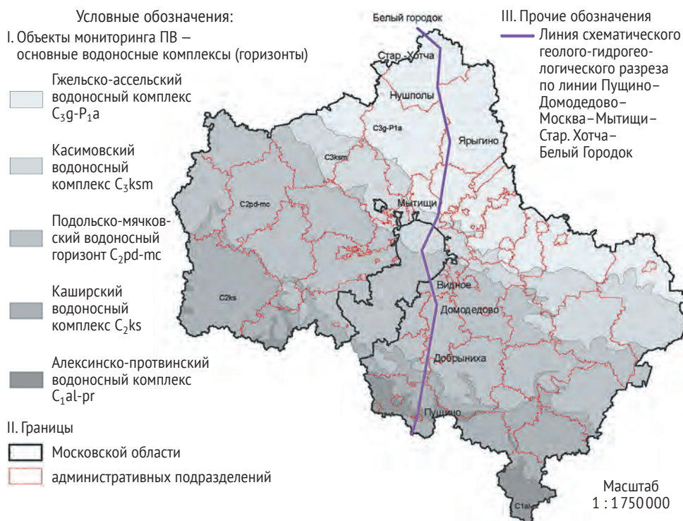
Рис. 14. Схема распространения основных (продуктивных) водоносных горизонтов и комплексов на территории Московского региона
